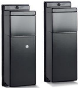
Einzellichtschrake in robustem Aluminiumgehäuse. Die Lichtschrake benötigt eine Referenzleitung zwischen Sender und Empfänger. Werden mehrere Lichtschraken an eine Meldergruppe der Einbruchmelderzentrale angeschaltet, wird zwingend das Erweiterungsmodul 9.30 mit Alarmspeicher (Art. Nr. 100032170) benötigt. Es sind bis zu 16 Lichtschraken in eine Richtung oder bis zu 30 wechselseitig verwendbar.
