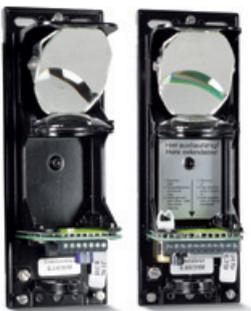
Kombinationslichtschanke zum Einbau in die Profilsäule 8.06/8.16. Zum Einbau in die Profilsäule 8.16 wird zusätzlich der Adapter 8.16A zur Befestigung benötigt. Die Kombinationslichtschanke ermöglicht den wahlweisen Betrieb mit oder ohne Referenzleitung. Mit Referenzleitung lassen sich max. 16 Lichtschränke in einer Richtung, ohne Referenzleitung max. 2 Systeme wechselseitig in einer Lichtwand verwenden.
