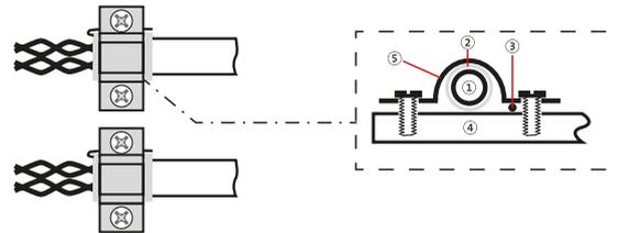
① Kabelmantel      ③ Beidraht      ⑤ Metallbügel
