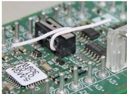
Die Adresse für BUS-1-Komponenten kann zwischen 1 und 63 am **DIP-Schalter S1** eingestellt werden. Um die gewünschte Adresse zu erhalten, müssen alle Zahlen (Werte unter dem Schalter), deren Schalter auf „ON“ stehen, addiert werden. Das 2-MGMV benötigt zwei Adressen. Die erste eingestellte Adresse ist für MG 1 zuständig. Die weitere Adresse wird automatisch mit der folgenden Adresse vergeben. Es dürfen am BUS-1 keine BUS-1-Komponenten mit gleicher Adresse vorhanden sein.
