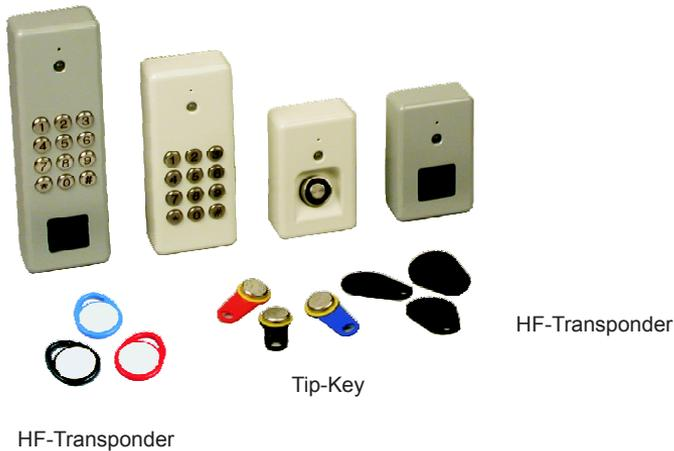
Die Leseinheit dient zur Übermittlung von Scharf-, Unscharf-Befehlen und Schaltbefehlen zur Einbruchmelderzentrale.
